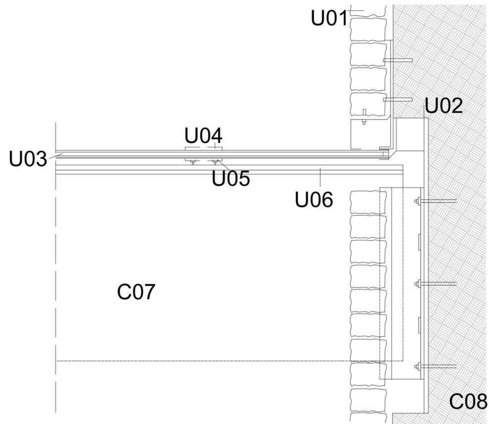
U01:Ladrillo existente extraído para colocación del vidrio y colocado posteriormente. Remates de chapa de hierro INOX e = 3mm.
